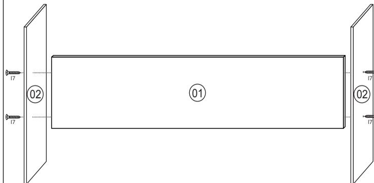
**3** \*\*\*Fixar o painel horizontal com parafusos
